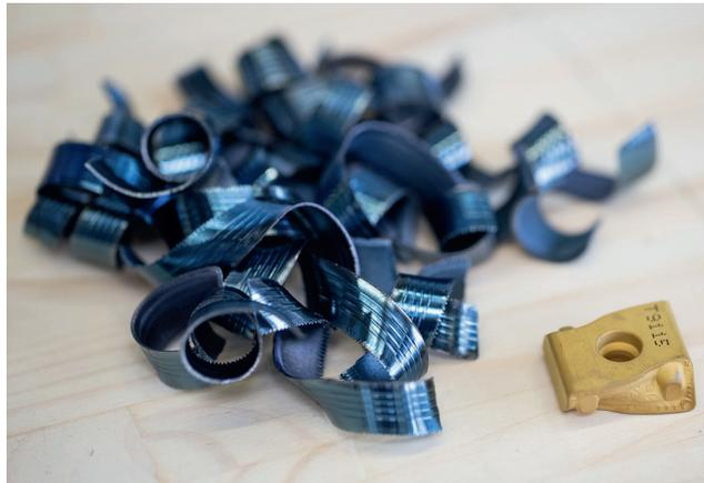
2 Günstig geformte, breite Späne entstehen beim Drehen mit der Wendeschneidplatte LNMX von Tungaloy. Ihre geschwungene Schneide bewirkt einen weichen Schnitt und kleine Zerspankräfte
